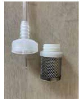
液肥タンク吸い込み口にはフィルターを取り付けてご使用ください。フィルター差込部にホースを差し込み、先端が網の中央あたりになるようにして下さい。
