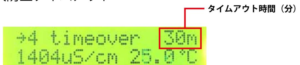
設定EC値より測定EC値が下がると液肥ポンプがON・OFFを繰り返しながら液肥投入を開始します。
